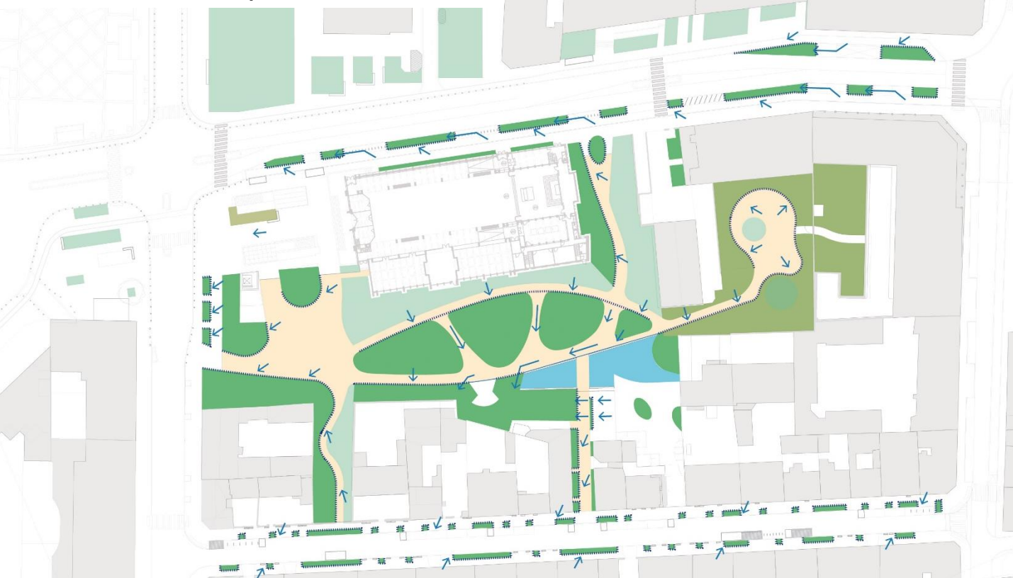
Infiltration des eaux pluviales
